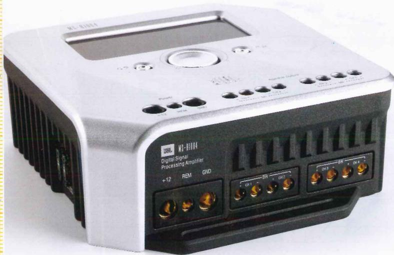
Le morsettiere sono completamente inglobate nel telaio; per praticità le serigrafie sono duplicate anche sul pannello superiore dove sono presenti dei fori attraverso i quali si raggiungono i grani filettati. In secondo piano il grande display e i tre comandi attraverso i quali si regolano tutti i parametri di funzionamento.
